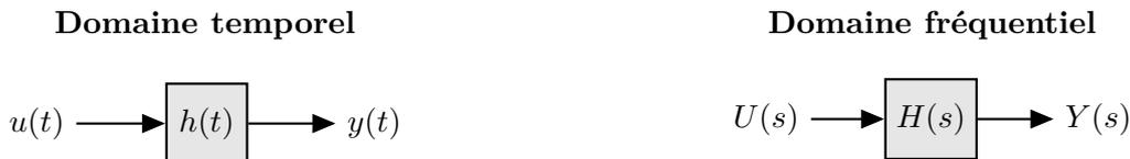
La réponse du système LTI s'obtient en faisant la convolution de l'entrée  $u(t)$  et de la réponse impulsionnelle  $h(t)$  :
