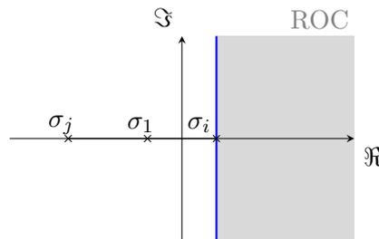
Pour trouver la ROC associée au système causal, on veut que la réponse impulsionnelle soit bornée à gauche ( $h(t) = 0 \forall t > 0$ ), et donc il suffit d'étudier les pôles de la fonction de transfert et de prendre le demi-plan ouvert à droite, limité par le pôle le plus à droite/le pôle le plus grand ♡.
