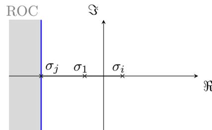
On peut également faire le lien avec la fonction de transfert exprimée sous la forme d'une expression rationnelle. Cette fonction de transfert a une ROC décrite par un demi-plan coupé parallèlement à l'axe  $j\omega$ , ouvert à gauche limité à droite par le pôle le plus à gauche.
